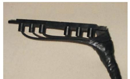
Vermutlich aus Kostengründen wurde die Lichtleitertechnik beim 72er Modell zu Gunsten eines dann serienmäßigen Diebstahl-Alarmsystems aufgegeben. Erstaunlicherweise wurde diese simple aber effektive Technik der Lampenkontrolle seitdem von keinem anderen Automobilkonstrukteur mehr aufgegriffen.
