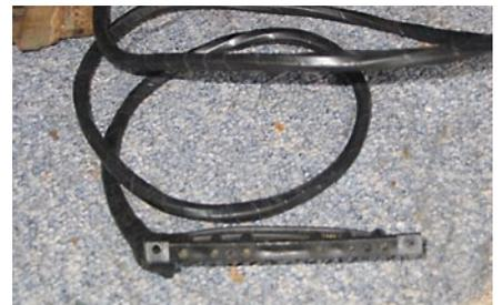
Unterbrechungen im Glasfaserkabel, z.B. durch einen Bruch, lassen sich einigermaßen gut reparieren: Hierzu werden die Bruchenden möglichst exakt gerade abgeschnitten (ggf. mit sehr feiner Nagelfeile nachpolieren), auf Stoß zusammengefügt und mittels zweier übereinander liegenden Lagen Schrumpfschlauch verbunden. Zwar ist die Lichtleitung nicht mehr so gut wie beim unbeschädigten Original, aber durchaus noch ausreichend.
