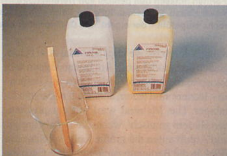
Das Basismaterial: Silikon-Kautschuk, der im Verhältnis 1:1 mit Härter angemischt wird.
